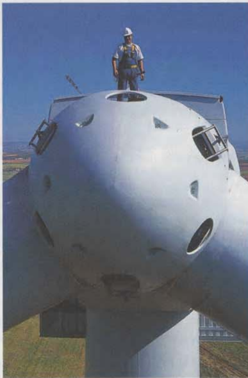
Avec 100 m d'envergure, une machine actuelle (ici en Espagne) produit plus de 3 MW.
